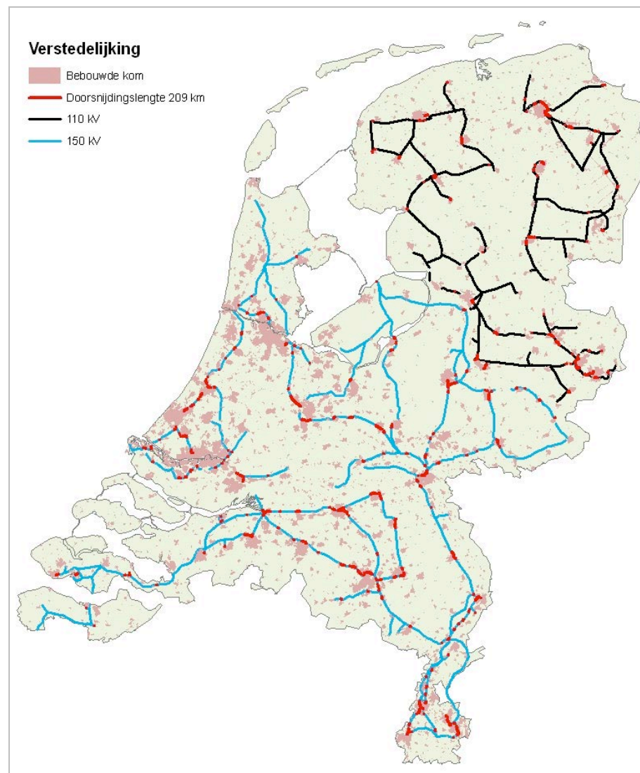
figuur 4.6a Doorsnijding Bebouwde kom.
