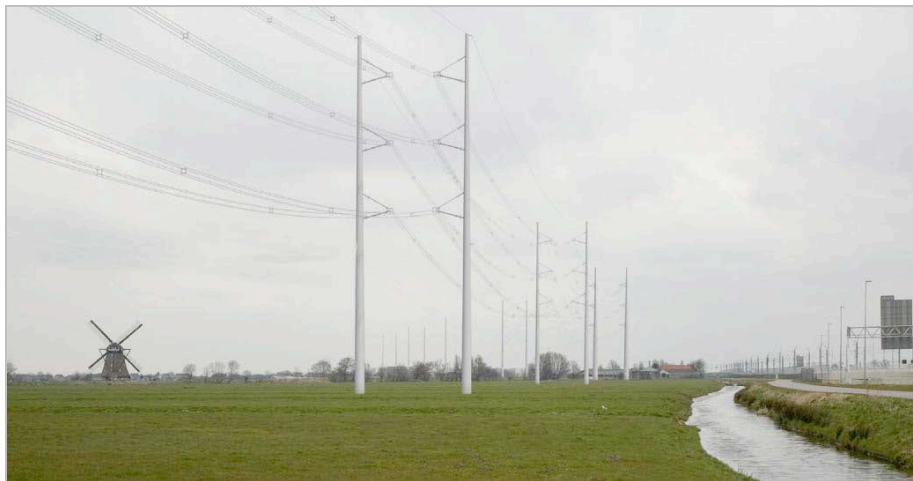
figuur 3d Computervisualisatie van 380kV verbinding met bi-pole masten (bron: TenneT).
