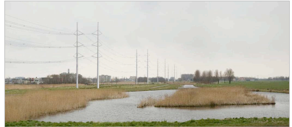
figuur 3e Computervisualisatie van 380/150kV verbinding met combinatie bi-pole masten (bron: TenneT).
